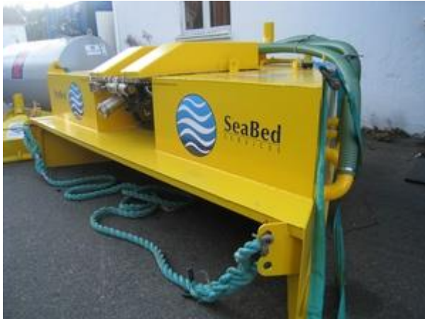
Foto: Seabed Services. Munnstykket til Seabed Services sugemudringsutstyr
