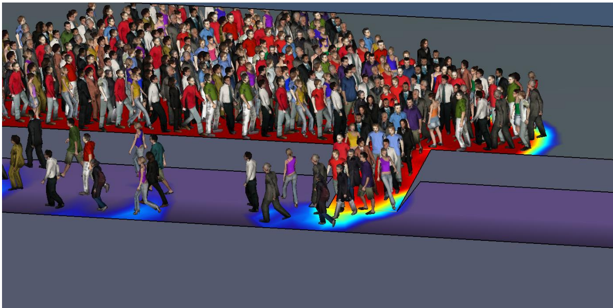
Figur 3. Illustrasjon av persontettheten ved landgangen mot gangbanen (Pathfinder).
