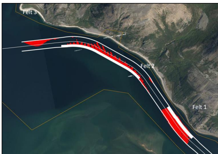
Figur 52 Oversikt over mudringsområdet ved alternativ 2A/2B. Mudringsområdene er angitt med rød skravur, mens sandfellene i utdypingsfeltene har hvit skravering. Hvite streker er farledsbegrensning på 120 meter og midtlinje. Kartet er ikke i målestokk. Kilde: Kystverket.
