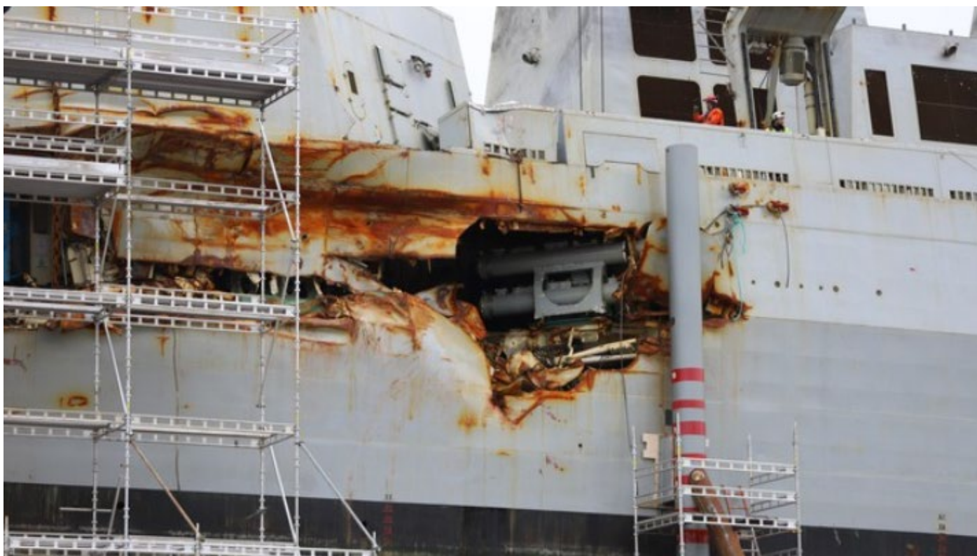
Bilde 2, Skader på KNM Helge Ingstad etter sammenstøtet. (Sysla.no – Bilder fra DNV GL rapport)
