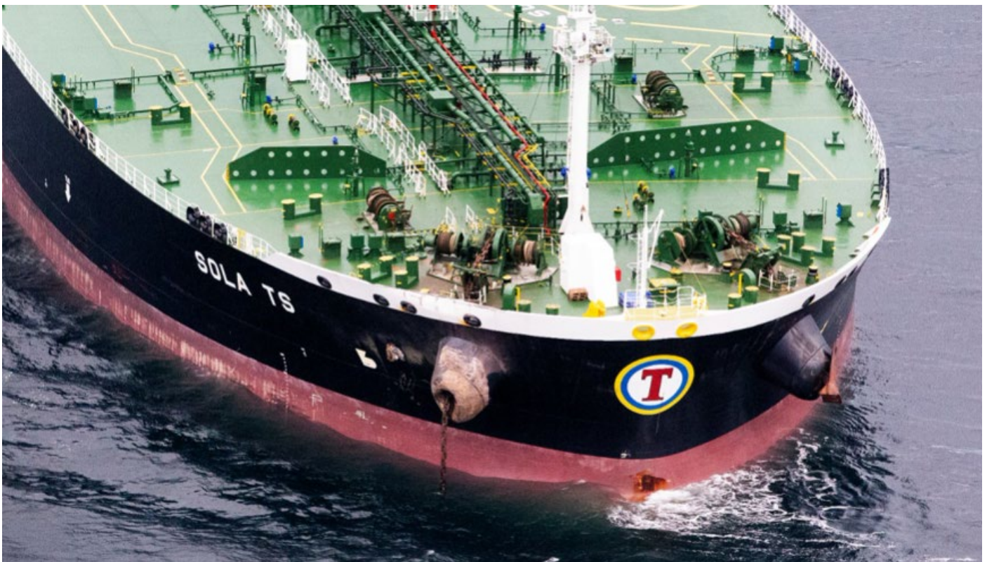
Bilde 1, Sola TS etter sammenstøtet. (Sysla.no – Bilder fra DNV GL rapport)
