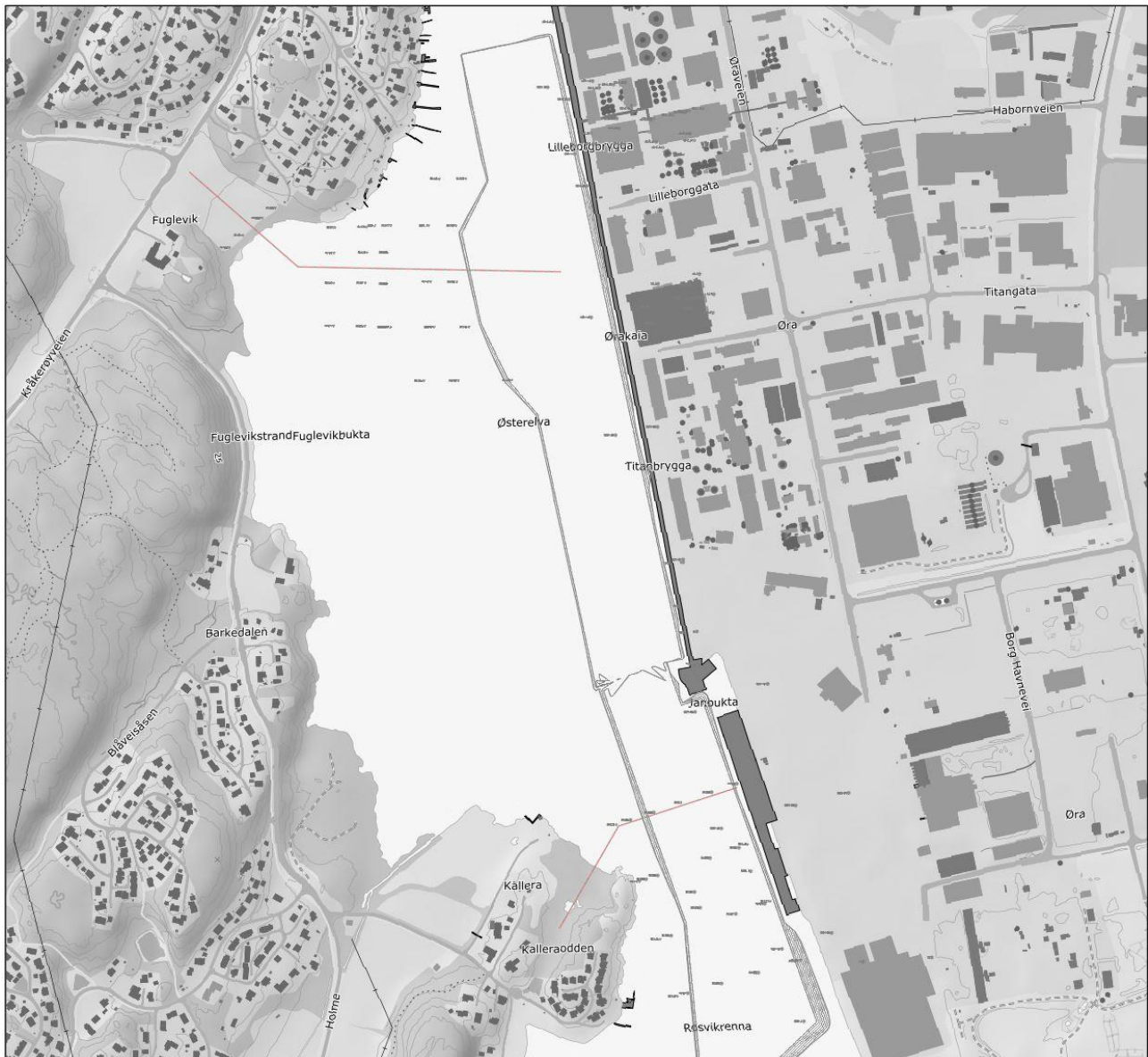
Figur 4 Beregningsprofiler for områdestabilitet. Beregninger inn mot kai er presentert i Norconsult-rapport 52103048-RIG-R02. Profil 1 i nord, profil 3 i sør.
