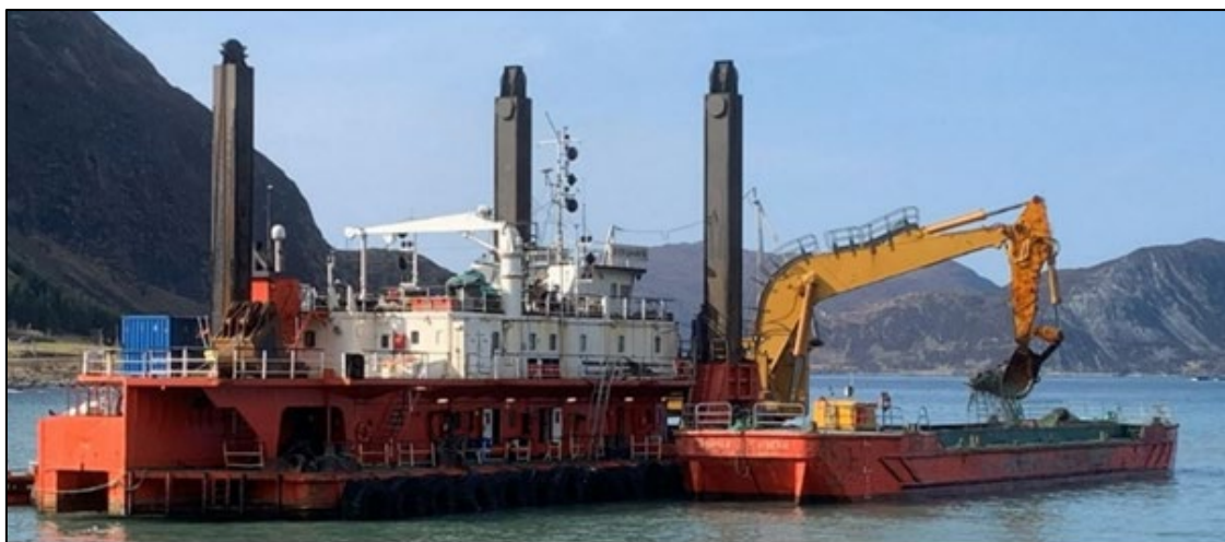
Figur 24 Mudringsfartøy i virksomhet. (Planbeskrivelse Multiconsult Gjennomseiling Herøy-Ålesund for Kystverket)
