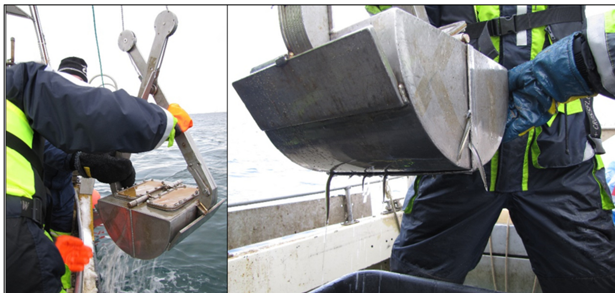
Figur 4. Van Veen-grabben som brukt under feltarbeidet og sampling av sil i Leirpollen og utenfor Tanaelva. Bildet til høyre viser sil som henger ut av grabben etter et vellykket grabbskudd i silhabitat på havbunnen. Foto: Ole Tobias Rannestad.
