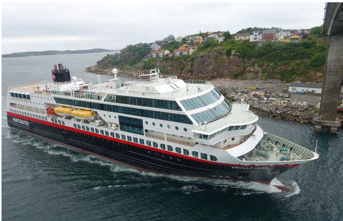
Foto 3-4 MS Trollfjord på tur inn Sørsundet. Den har både bulb og stort overheng.
