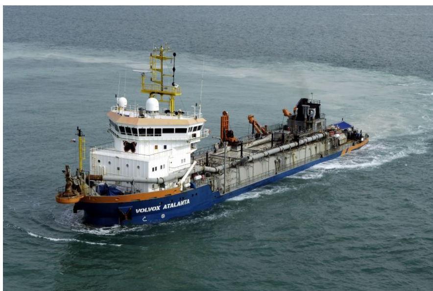
Figur 2.3 Bilde av mudring med en typisk sugemudrer.
