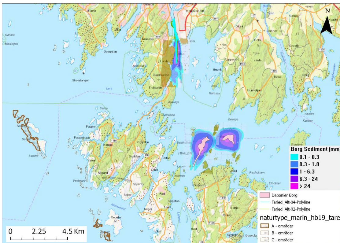
Figur 6 Spredningsmodellering av partikler under mudring av farled til Borg havn og deponering av masser ved Møkkalasset og Svaleskjær ved bruk av grabb med wire hentet fra SINTEF, 2018. Områder med tareskog er skravert med brunt.
