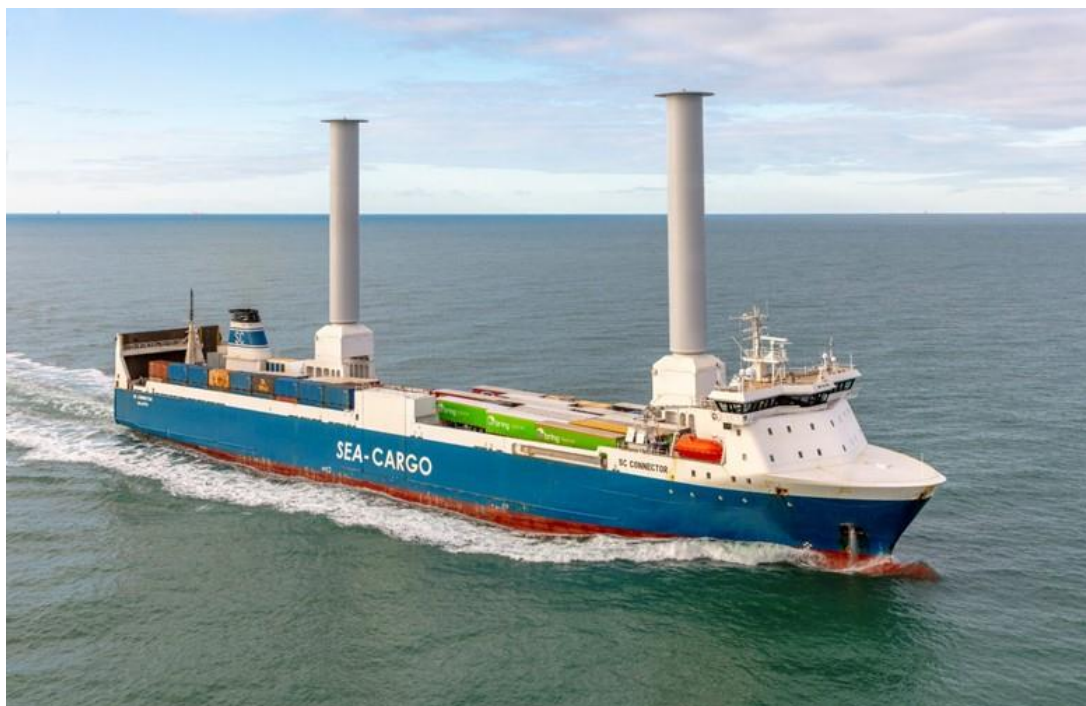
Figur 48: RoRo-skipet SC Connector operert av SeaCargo. Skipet fikk i 2020 installert to rotorseil.
