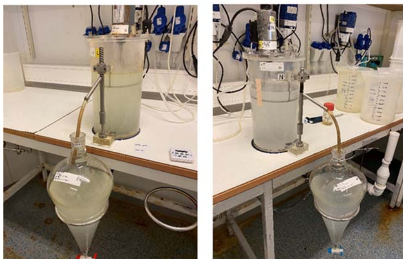
Figur 7-12 Dispergeringstesting på IFP for B100 til venstre og HVO 250°C+ til høyre.
