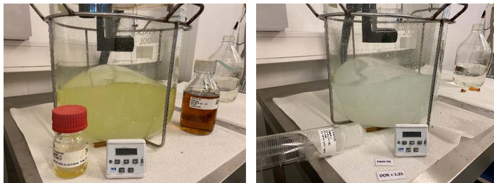
Figur 7-13 Dispergeringstesting på MNS for B100 til venstre og HVO 250°C+ til høyre.
