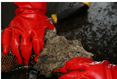
Bilde 6 viser snitt gjennom sorbent som har ligget i MGO i 30 minutter, vanntemperatur var 10°C
