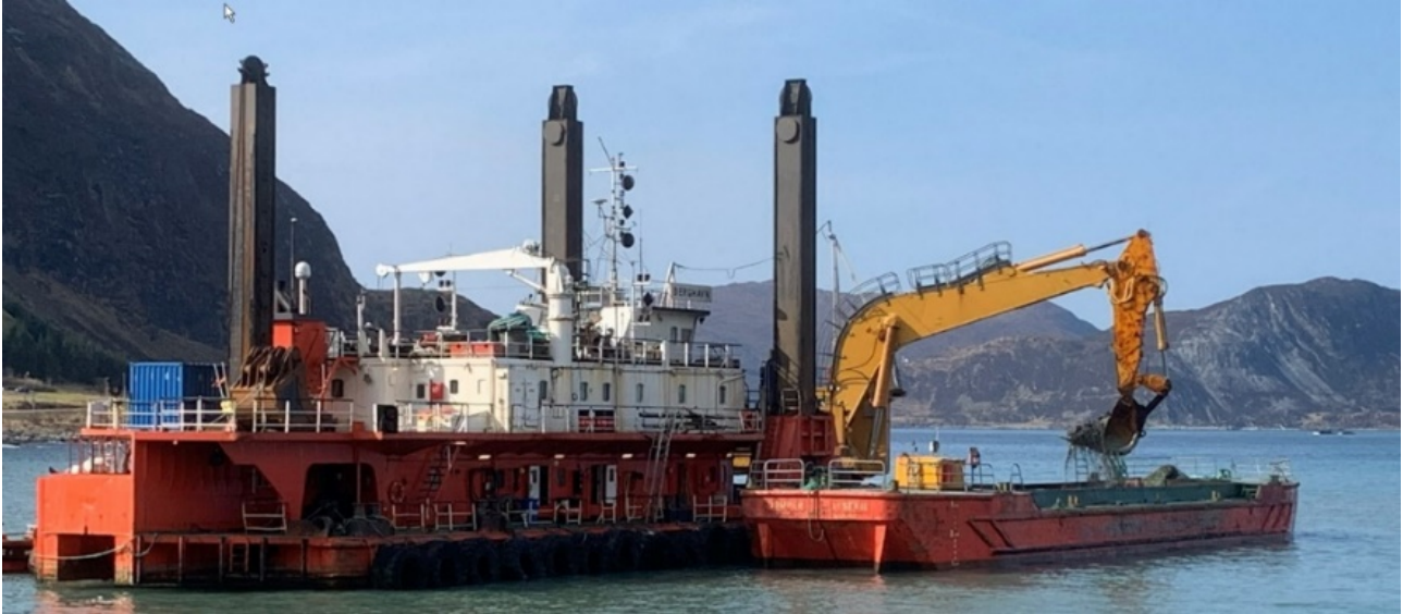
Figur 2. Mudringsfartøy med grabbe og split lekter. Foto: Ole Bjørn Molnes, Gjerdsvika 3 april 2019
