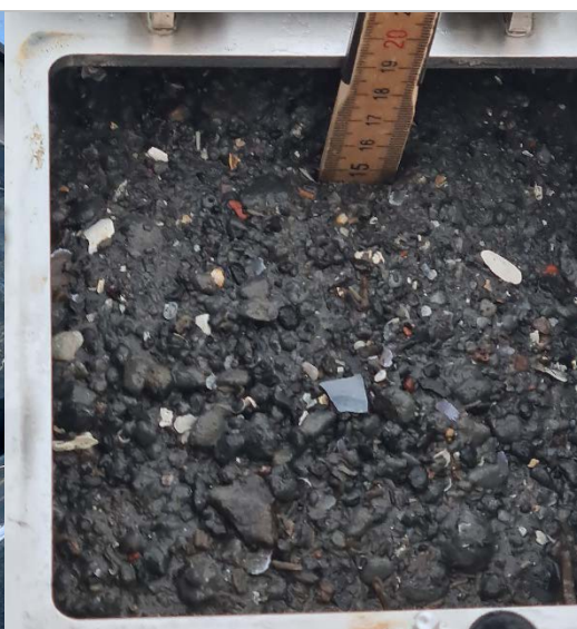
Figur 4-23 Stasjon ETTER-S7 (topplag), område med høyest mektighet av deponerte masser
