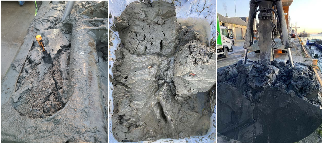
Figur 3-29 Bilder fra prøvetaking av mudrede masser fra felt Nord (til venstre) og felt Midt (i midten lekter 4 og til høyre lekter 6) ved uttak av masser til blandprøve.
