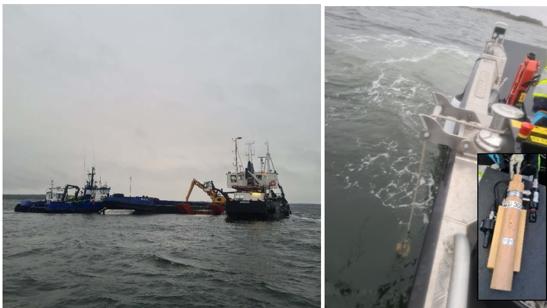
Figur 4-2 Lekter med mudrede masser og nedføringsenhet om bord på Arna ute ved Svaleskjær (til venstre), samt bilde fra senking av manuell måleutstyr for overvåking av turbiditet (til høyre).
