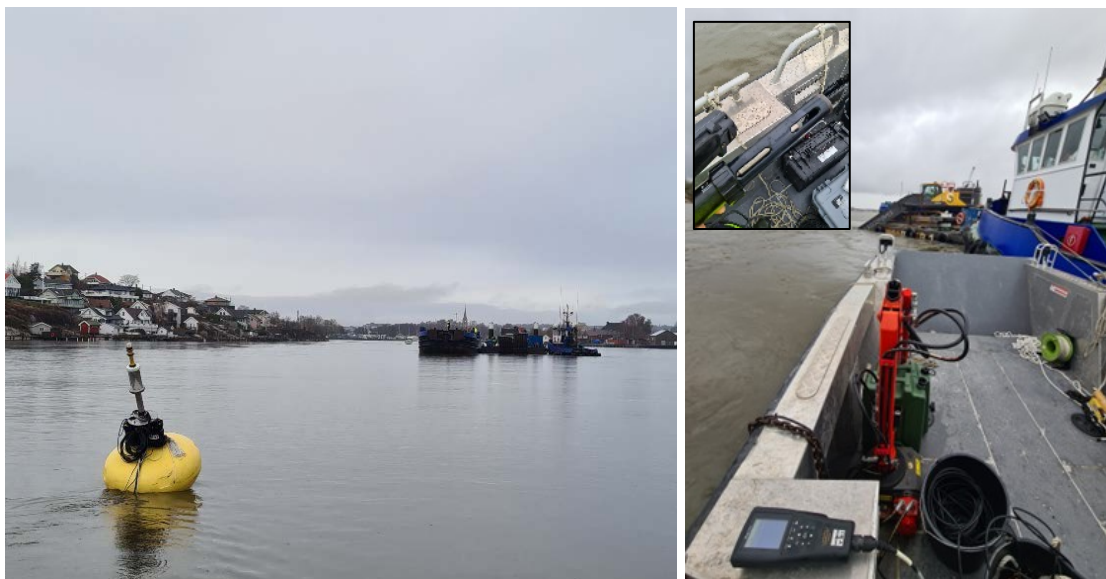
Figur 3-2 Stasjonær målebøye for kontinuerlig overvåking av turbiditet nedstrøms for mudringsfeltet, her vist for felt Nord (til venstre), og håndholdt måleapparat brukt for manuelle målinger i farleden fra FF Kolstad, her vist like sør for mudrepremmen i felt Midt (til høyre).
